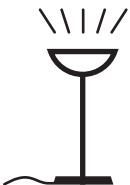
indirekt abstrahlend z.B. 40-Watt-LED
